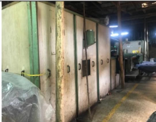
Fotografía 5. Horno de secado y templado
